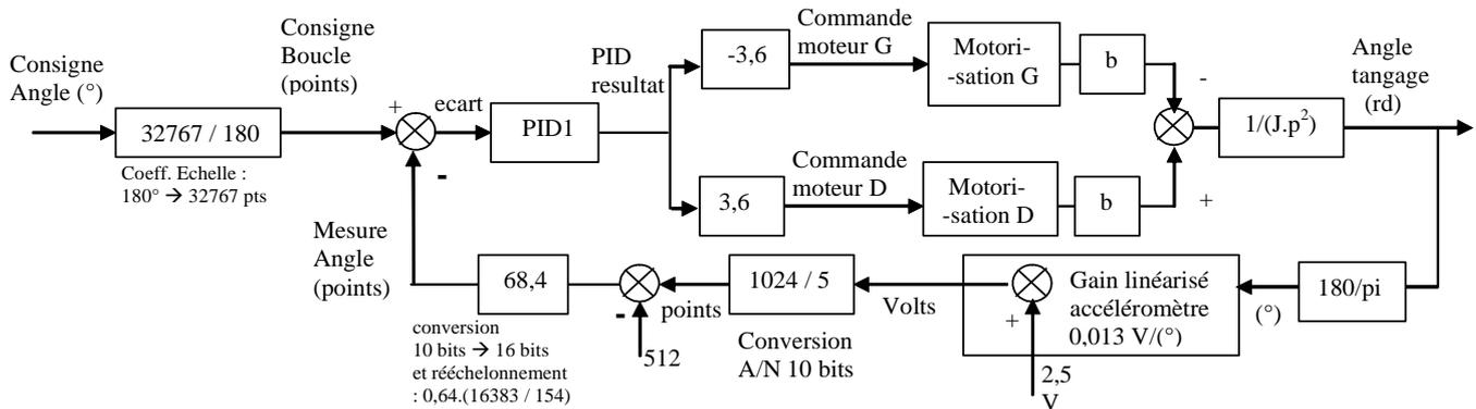
Q - 2 : *Déterminer la forme des blocs PID et moteur.*
