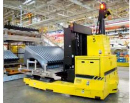
Les chariots sont mis en mouvement par des moteurs électriques alimentés par des batteries embarquées.
