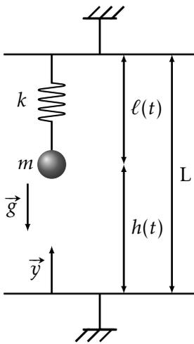
Pour commencer, partons d'un système masse-ressort. La masse vaut  $m$  et le ressort a pour constante de raideur  $k$  et pour longueur à vide  $\ell_0$ .
