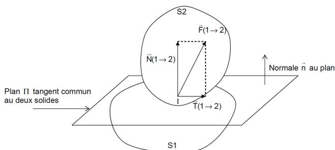
La force  $\vec{F}_{(1 \rightarrow 2)}$  doit donc être située dans le cône de frottement de demi angle au sommet  $\varphi$  tel que  $f = \tan \varphi$
