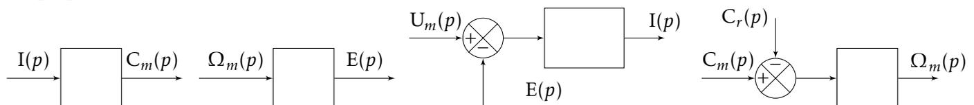
2.3.2 Schéma bloc du moteur à courant continu
