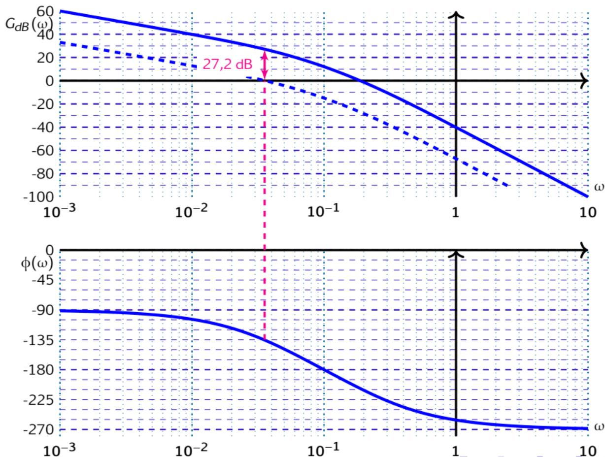
Q - 5 : Déterminer par le calcul un nouveau gain  $K$  pour que la marge de gain soit  $M_G = 8$  dB.
