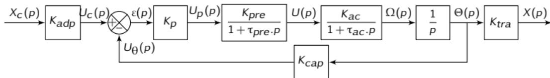
Pour que le système soit correctement asservi,  $K_{adp} = \frac{K_{cap}}{K_{tra}}$  et on pose  $K = K_{adp} \cdot K_p \cdot K_{pre} \cdot K_{ac}$  et on donne  $\tau_{pre} = 5$  s et  $\tau_{ac} = 20$  s.
