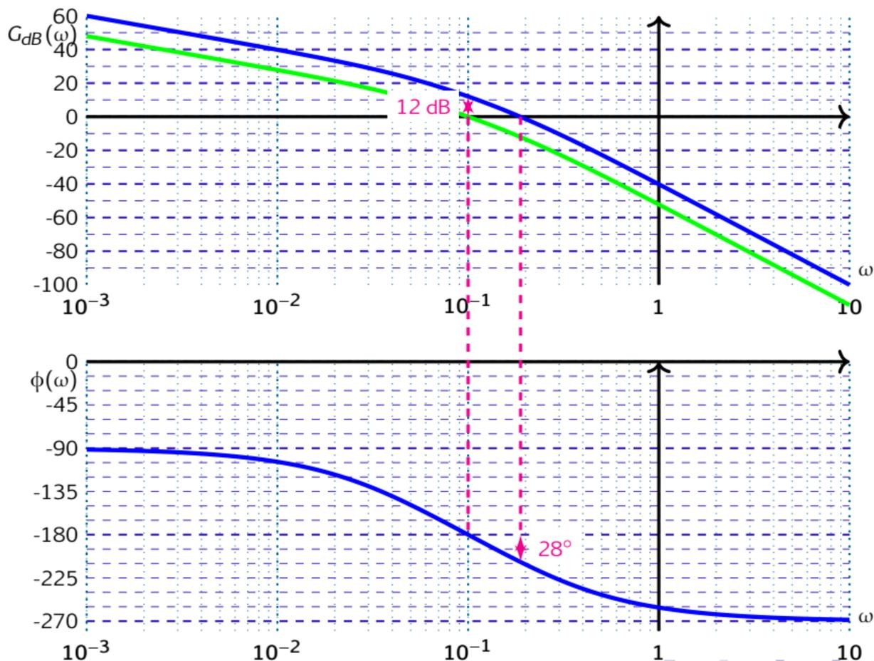
Q - 4 : Déterminer graphiquement un gain  $K$  pour que le système soit en limite de stabilité.
