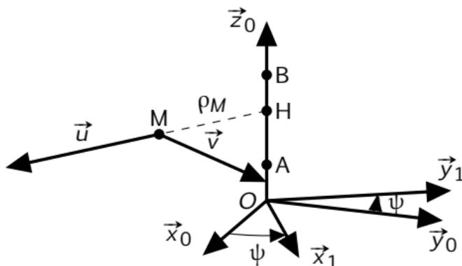
Si la vitesse des points  $A$  et  $B$  est nulle dans  $\mathcal{R}_0$ , alors  $\vec{\Omega}_{(S/R_0)} // \vec{AB}$ , et tout point de la droite  $(BA)$  a une vitesse nulle.
