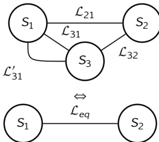
Supposons qu'il existe entre deux pièces  $S_1$  et  $S_2$  plusieurs liaisons réalisées avec ou sans pièces intermédiaires.
