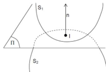
Soient deux solides  $S_1$  et  $S_2$  en contact en  $I$ .
